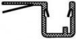
AC6845060-2 ACTIV TÜRECKANSCHLAG- DICHTUNG MIT WEICHLIPPE GERADE FÜR 6-8MM GLAS LÄNGE 2010MM
