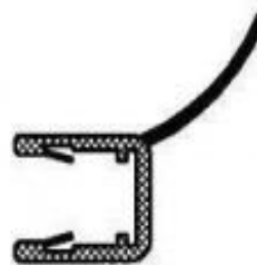
AC6845071-2 ACTIV WANDANSCHLUSS EXTRA LANG WASSERABWEISER 135° 6-8 MM, 2010 MM
