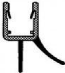
AC6845090-2 ACTIV LIPPENDICHTUNG MIT WASSERABWEISER 135° 10-12MM GLAS, LÄNGE 2010MM
